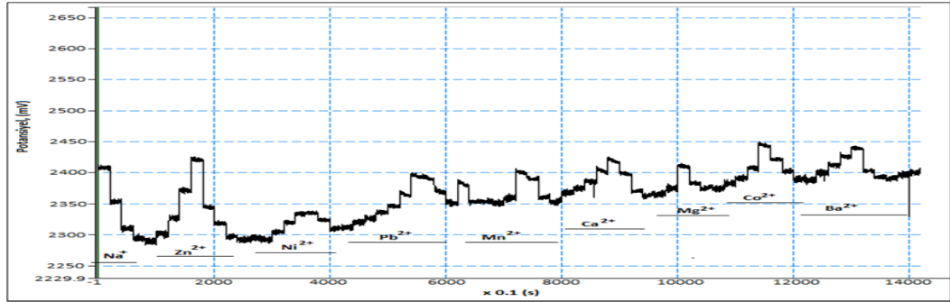
Şekil 7. Hazırlanan kompozit membran elektrotun metal iyonlarının konsantrasyon değişimine karşı potansiyometrik davranışı
