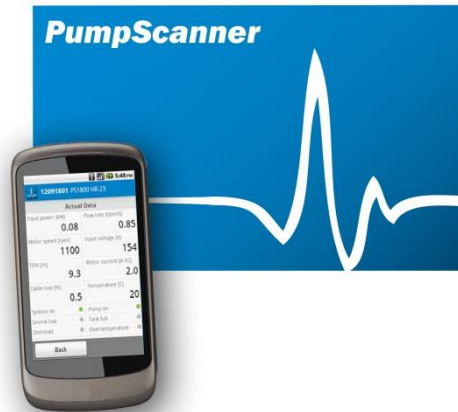
Şekil 11. Lorentz controller – inverter cihazında kullanılan veri transferi yazılımı.
