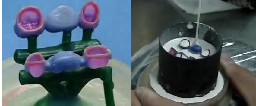
Şekil 7. Mum kalıba diş kalıbının dökümü [14].
